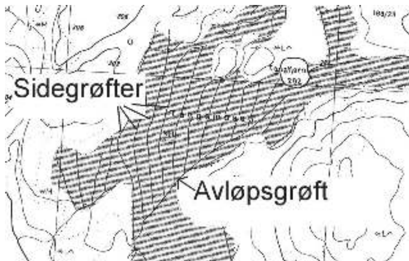
Figur 25. Grøftesystem med sidegrøfter og avløpsgrøft for drenering av myr.
